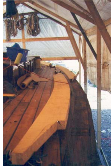
Skandekk klart til montering
