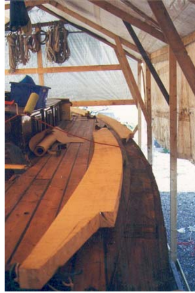
Skandekk klart til montering
