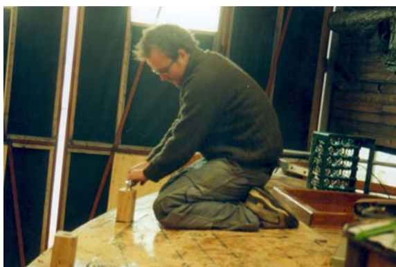
Rekkestøttene er boltet gjennom skandekk og bjelkelag
