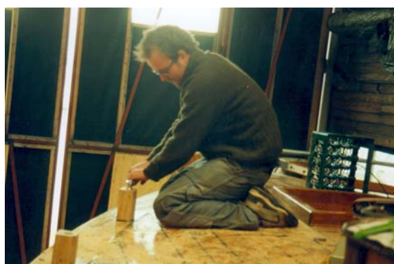
Rekkestøttene er boltet gjennom skandekk og bjelkelag
